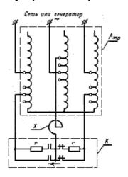
$A_{mp}$  - испытательный автотрансформатор или трансформатор; X - нагрузочный реактор; X - контактор (переключатель нагрузки) с токоограничивающими резисторами)
