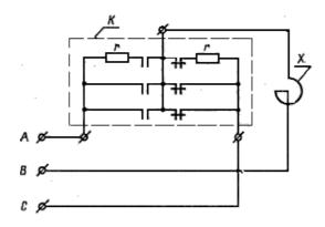
$\mathit{X}$  - нагрузочный реактор;  $\mathit{K}$  - контактор (переключатель нагрузки) с токоограничивающими резисторами
