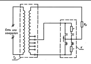
$R_{\tt H}$  - нагрузочный резистор;  $T_{\tt p}$  - испытательный трансформатор или автотрансформатор; K - контактор (переключатель нагрузки) с токоограничивающим резистором
